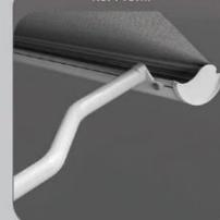
Pencere tentesi kol profili T5 6063 yüksek mukavemetli allüminyum elektrizyon profillerinden imal edilir. 75 x 37 mm ebatlarında ve 3 mm et kalınlığındadır. Bu sistem içerisinde gergin açılmayı sağlayan içi yaylar bulunmaktadır.
