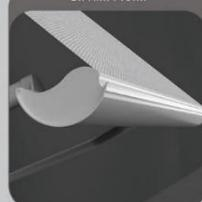
Pencere tentesi ön alın profil T5 6063 yüksek mukavemetli allüminyum elektrizyon profili olarak imal edilir. 145 x 73 mm formunda olup metre ağırlığı 2026 g/m gelirken profildir. Piyasa şartlarına göre üstün bir malzeme dir. Bu sistemde kullanılmıştır. İçi yaylar olan tente kol ve kumagın bantları uyumlu çalışmasında önemli bir aktör olmasındadır. Ayrıca ön alın profilli tenterin yağmur suyunun yönlendirilmesi için yağmur kanallı tasarlanmıştır.
